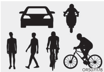
위 그림은 인식 센서가 차량, 이륜차, 보행자 및 자전거 탑승자로 인지 가능한 이미지 예시입니다.
