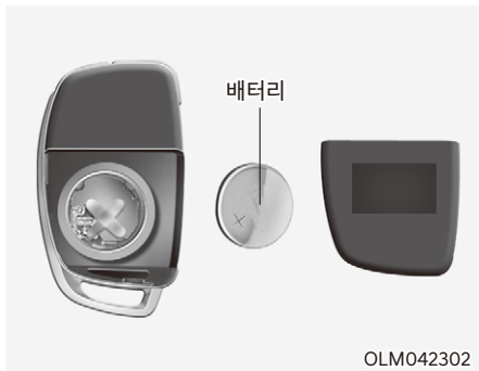
[A] : 건전지 커버, [B] : 배터리
